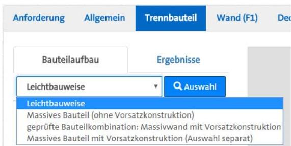
Mit der Wahl des Konstruktionstyps - im Folgenden beispielsweise „Leichtbauweise“ - wird einerseits das Rechenverfahren und andererseits dann die unter dem Button „Auswahl“ die weitere Datenbankauswahl bestimmt.
