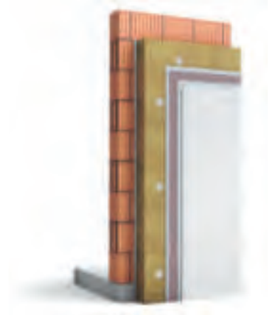
Das WDVS weber.therm A 100 setzt sich aus einem mineralischen Klebemörtel, Mineralwolle als Dämmstoff, Dübel zur zusätzlichen Befestigung, einer mineralischen Armierungsschicht und einem mineralischen Oberputz zusammen.
