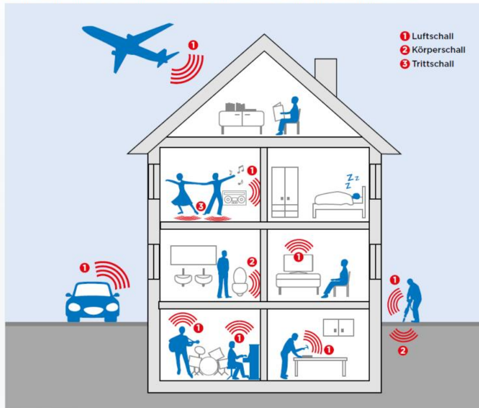
Beispiele für die unterschiedlichen Schallquellen und Schallübertragungswege in einem Bauwerk
