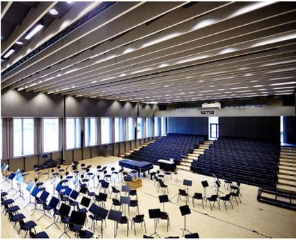
Der Kernpunkt dieses Projekts ist die Konstruktion der Akustikdecke im Auditorium des Instituts für Kunst und Musik der Universität Augsburg. Der innovative Projektaspekt ist die Erfüllung der Akustikanforderungen ohne spezielle Akustikplatten, sondern durch die intelligente, spezielle Montage von Rigidur-Platten. Das gesamte Bauvorhaben wurde gemeinsam von Akustikexperten und Statikern speziell für dieses Projekt entwickelt.
