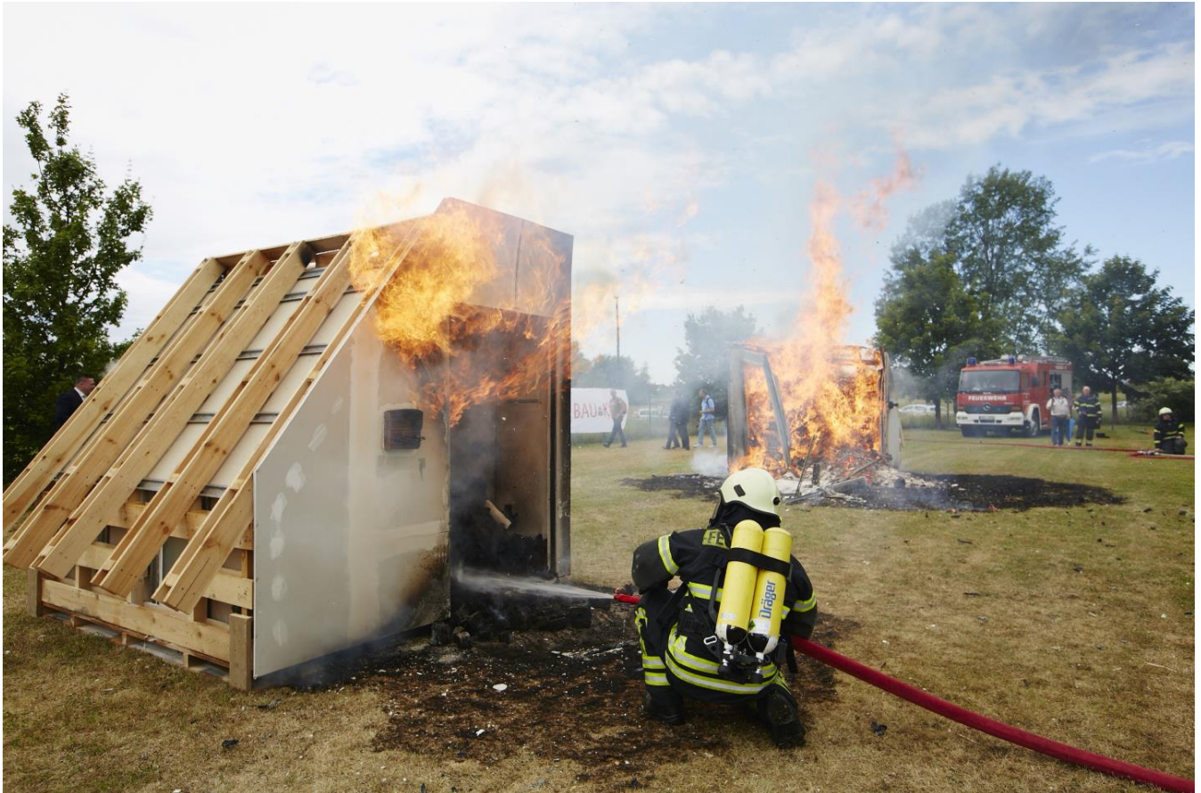
Beispiel einer Brandausbreitung: Vergleich von Konstruktionen mit korrekt ausgeführtem baulichen Brandschutz (Vordergrund) und ohne (Hintergrund).
