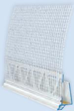
Das Aufsteckprofil in 12 mm für die Anwendung der Rigips Glasroc X als direkt verputzte Platte schafft einen exakten Putzabschluss beim Übergang zu angrenzenden Bauteilen sowie eine saubere Tropfkante durch gezielte Wasserführung im Sockelbereich.
