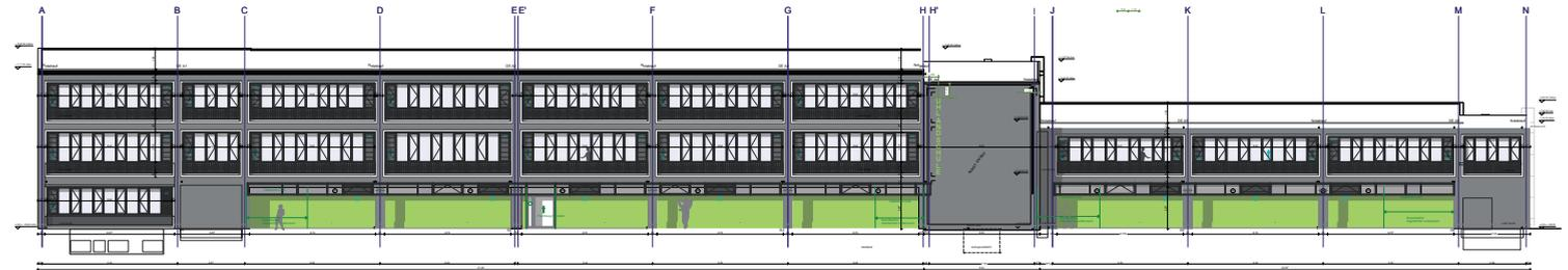
Nordansicht: Zusätzliche Fenster und Lichtbänder für mehr Tageslicht und effektive Nachtlüftung / North view: Additional windows and strip lighting for more daylight and effective ventilation at night
