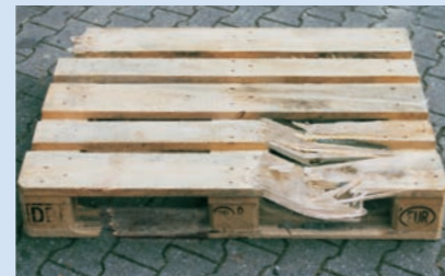
Mehr als 3 Bauteile defekt
