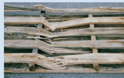
Mehr als 3 Bretter defekt
