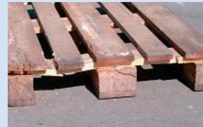
Querbrett gebrochen oder so beschädigt, dass mehr als 1 Nagel sichtbar ist (Querbrett = 80 cm; schmale Seite)
