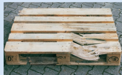
Mehr als 3 Bauteile defekt
