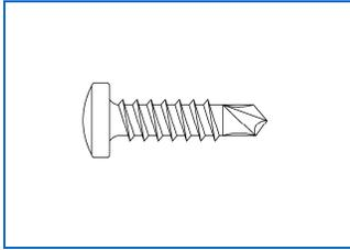
Rigips Befestigungsschrauben dienen zur Verbindung (Blech in Blech) von Unterkonstruktionsbauteilen in Gipsplattensystemen. Sie werden aus Stahl gefertigt und sind phosphatiert. Rigips Befestigungsschrauben verfügen über einen Linsenkopf, ein Feingewinde und eine Bohrspitze. Die Verwendung erfolgt für die Verschraubung von Blechen mit  $t \leq 2,0$  mm. Rigips Befestigungsschrauben sind in den Abmessungen 3,5×9,5 mm, 4,8×16 mm, 4,8×19 mm und 4,8×25 mm verfügbar.
