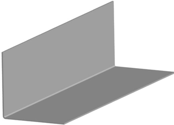
Rigips Winkelprofile 50/50-07 sind korrosionsgeschützte Metallprofile, die zur Ausbildung von Anschlüssen und Eckverbindungen in Gipsplattensystemen dienen. Das Rigips Winkelprofil 50/50-07 ist gleichschenkelig und weist eine Schenkellänge von 50 mm auf. Die Länge der Profile beträgt 3.000 mm. Rigips Winkelprofile 50/50-07 werden aus verzinktem Stahlband gefertigt.
